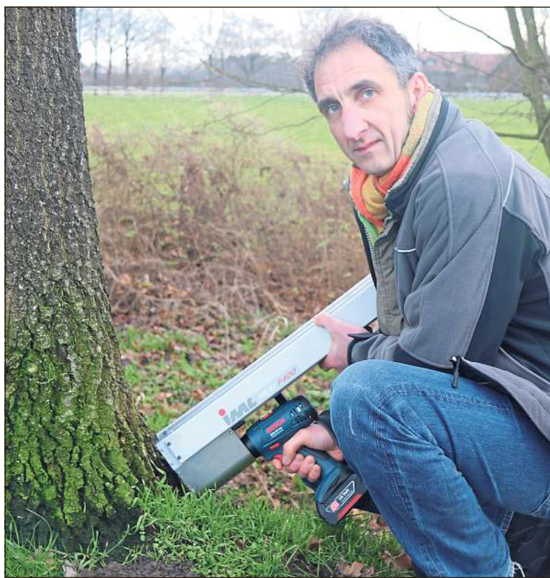
Präzise Messung: Mit dem Resistograph kann der Baumkontrolleur herausfinden, wie weit sich die Fäule ausgebreitet hat.
